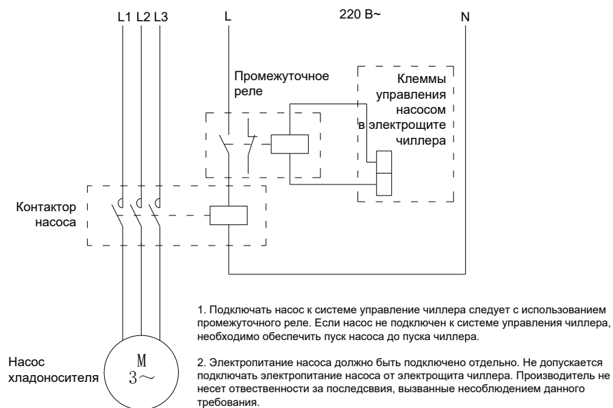
Рис. 5.1. Схема подключения насоса хладоносителя
