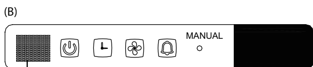
Приемник ИК-сигнала Светодиодный дисплей
