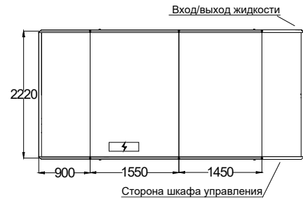
Рисунок 6-7. Вид сверху на схематический чертеж с монтажными размерами моделей MCDH350/375/400B-PR3
