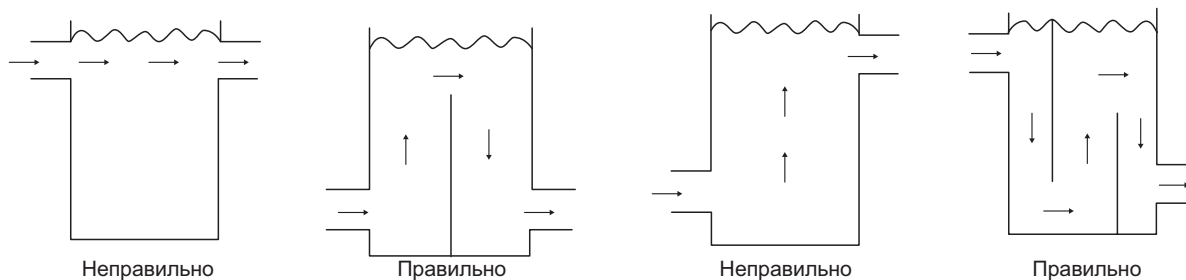
Рисунок 8-19. Конструкция накопительного бака
