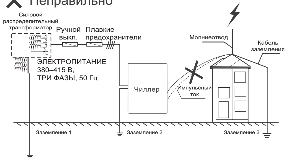
Рисунок 8-9. Требования к проводке электропитания
