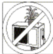
Позаботьтесь о том, чтобы никакие предметы не блокировали отверстия для входа и выхода воздуха
