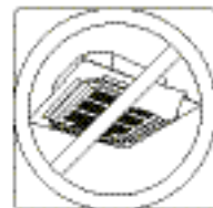
Позаботьтесь о том, чтобы никакие предметы не блокировали отверстия для входа и выхода воздуха
