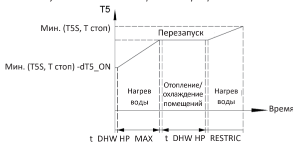
Рисунок 3-7.9: Работа в режиме приоритета БГВ
